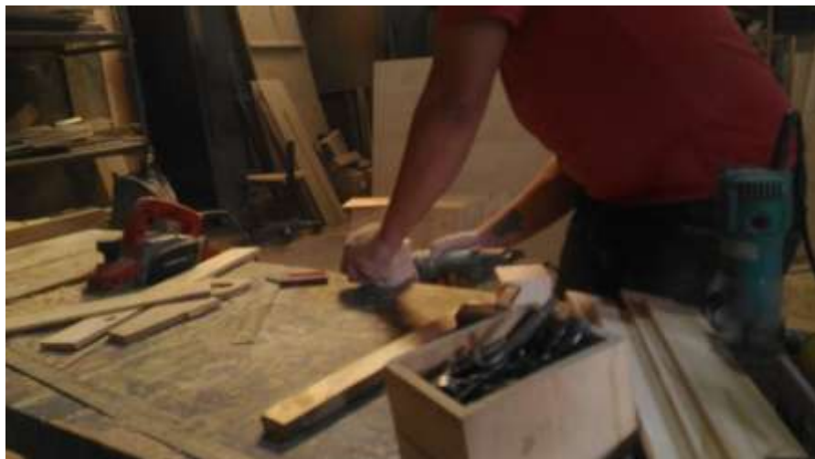
Gambar 3.24 Proses Penghalusan Kayu dengan mesin Sumber: Dokumentasi pribadi, 2018
