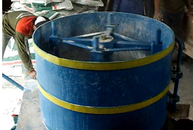
Gambar 3.35 Contoh mixer yang dipakai untuk pemasangan castable . (Sumber: semen-tahanapi.com, 2014)
