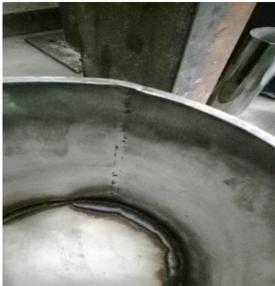
Gambar 3.26 Hasil pengelasan untuk kowi peleburan (Sumber: Dokumentasi Pribadi)
