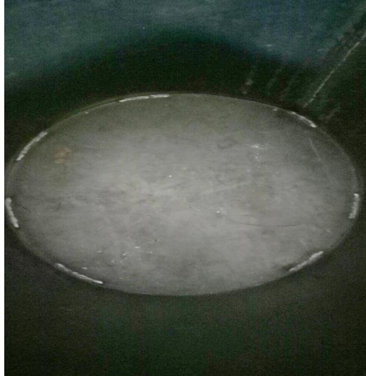
Gambar 3.12 Hasil dari pengelasan casing tungku crucible (Sumber: Dokumentasi Pribadi)
