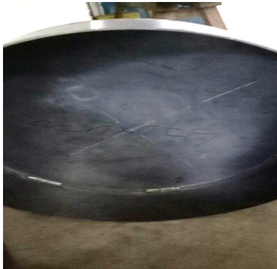
Gambar 3.19 Hasil pengelasan pada tutup tungku (Sumber: Dokumentasi Pribadi)
