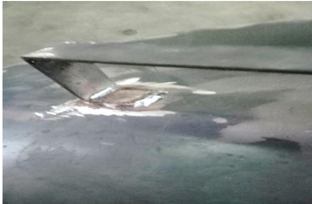
Gambar 3.22 Hasil pengelasan pada gagang tungku (Sumber: Dokumentasi Pribadi)
