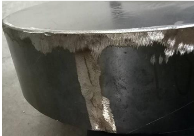
Gambar 3.20 Hasil finishing dari pengelasan (Sumber: Dokumentasi Pribadi)
