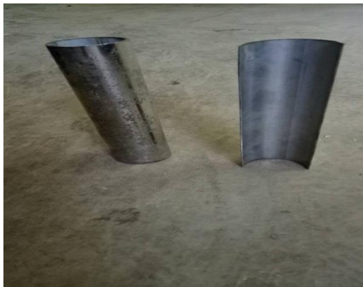
Gambar 3.28 Pipa stainless steel yang sudah dibelah (Sumber: Dokumentasi Pribadi)
