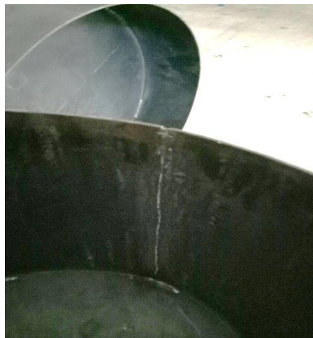
Gambar 3.13 Hasil pengelasan sisi ujung setelah pengerollan (Sumber: Dokumentasi Pribadi)
