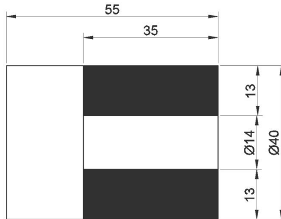
Gambar 3.7 Bubut rata dari \text{Ø}40 mm menjadi \text{Ø}14 mm sepanjang 35 mm menggunakan pahat bubut kanan HSS
