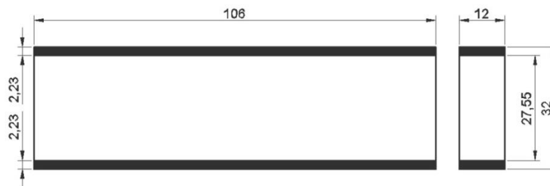
Gambar 3.18 Frais muka dari lebar 32 mm menjadi 27,55 mm sepanjang 106 mm menggunakan face mill \varnothing 40 mm
