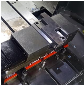
Gambar 1.6 Pemasangan Stopper Untuk Proses Pemesinan
