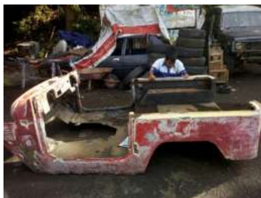
d. Proses Perbaikan Body Toyota FJ40
