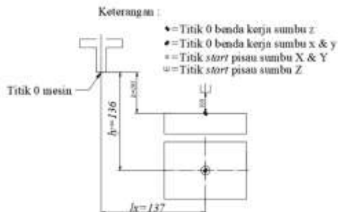
Gambar 1.26 Ilustrasi pergerakan bebas centerdrill
