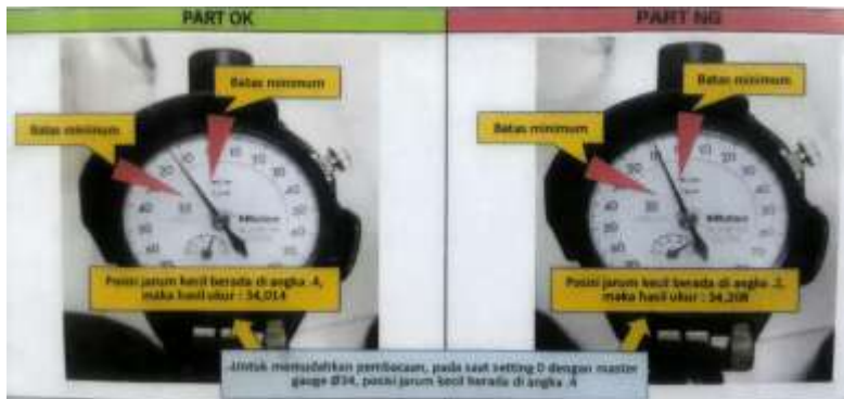
Gambar 1.36 Cek hasil produksi dengan borring gage ( Sumber : PT. Perkakas Rekadaya Nusantara )
