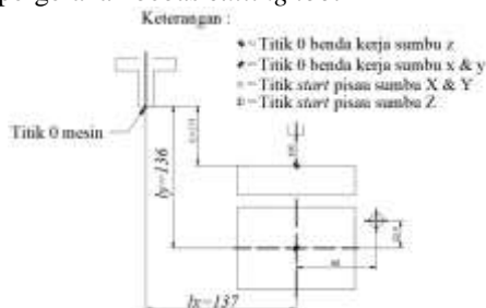
Gambar 1.23 Ilustrasi pergerakan bebas milling atas
