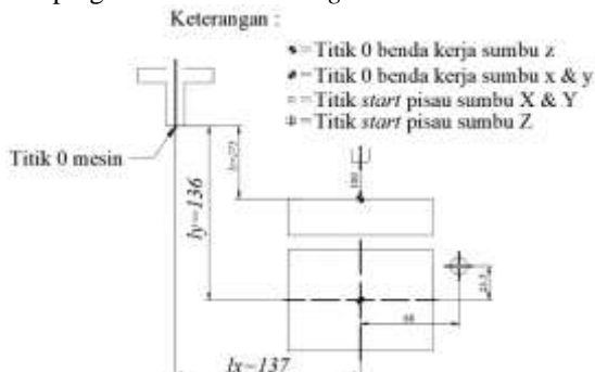
Gambar 1.30 Ilustrasi pergerakan bebas milling bawah
