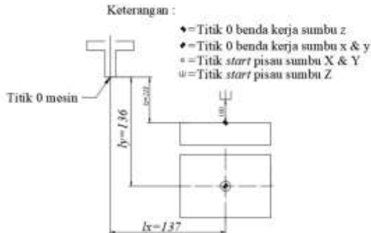
Gambar 1.27 Ilustrasi pergerakan bebas drilling \phi 7
