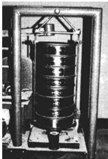
Gambar 3.4 Pengayak Pada Uji Saringan
