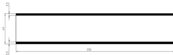
Gambar 1.16 Frais Muka dari tebal 40 mm menjadi 35 mm sepanjang 230 mm menggunakan face mill Ø25 mm.
