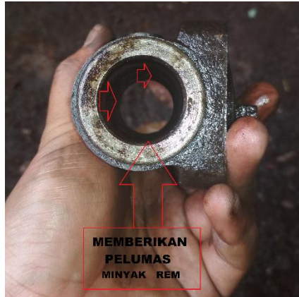
(Gambar Error! No text of specified style in document..9 Memberikan Pelumasan Pada Dinding Silinder Roda )
