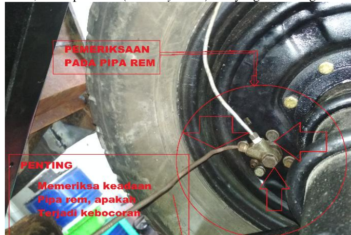
(Gambar Error! No text of specified style in document..7 Pemeriksaan kebocoran pada pipa rem dan Niple rem yang terhubung ke sepatu rem )
