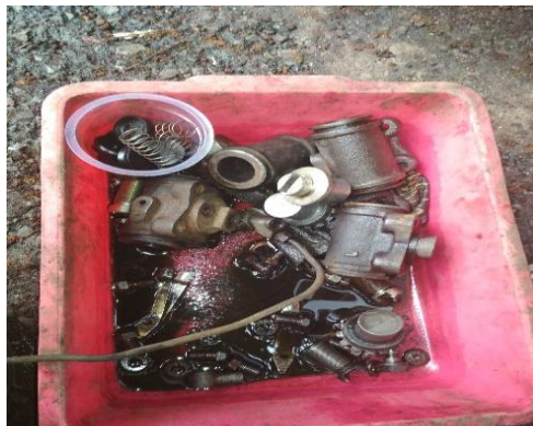
(Gambar Error! No text of specified style in document..11 Komponen wheel cylinder saat akan di bersikan )
