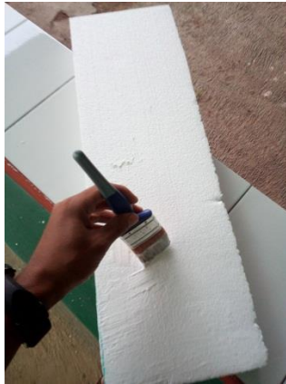
Gambar 3.26 Mengolesi styrofoam dengan lem kayu (sumber: Dokumentasi Pribadi)
