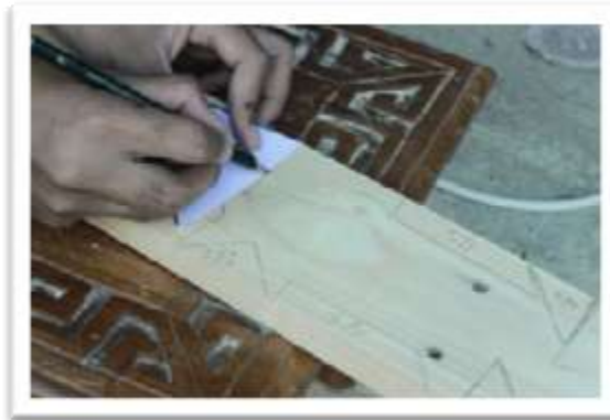
Gambar 3.32: Pembuatan Pola Pada Kayu Sumber: Dokumentasi Pribadi, 2017
