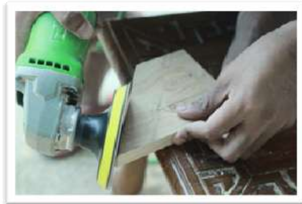
Gambar 3.34 Proses Penghalusan Kayu Sumber: Dokumentasi Pribadi, 2017
