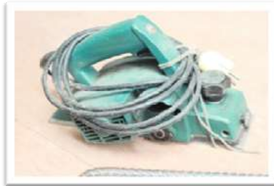
Gambar 3.14: Mesin Serut Kayu Sumber: Dokumentasi Pribadi, 2017
