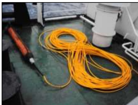
Gambar 3.4 Sensor Marine Magnetometer dan Kabel Data.
