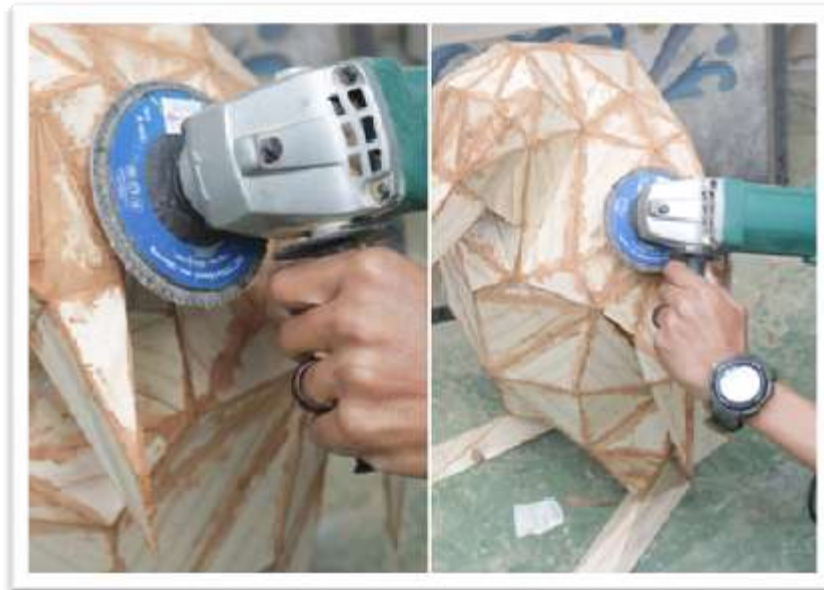
Gambar 3.48: Menghampas dengan Grinder Sumber: Dokumentasi Penulis
