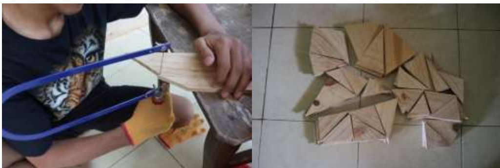
Gambar 3.42: Pemotongan Bentuk dengan Gergaji Kawat. Sumber: Dokumentasi Penulis
