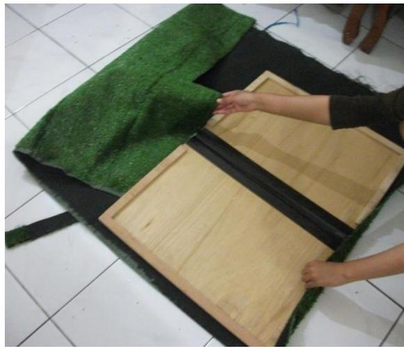
Gambar 1.56 Pemasangan Rumput Sintetis pada triplek
