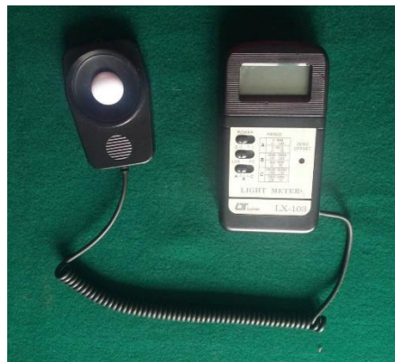
Gambar 3.1. Alat Pengukur Intensitas Cahaya Luxmeter Sumber: dokumentasi pribadi
