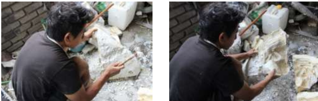
Gambar 3.36 Proses Pelepasan Cetakan dengan Gipsum (sumber: Rizqi Fauzi, 2017)
