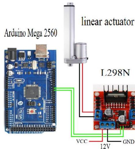
Gambar 3.6 Visual Skematik Driver *Linear Actuator*
