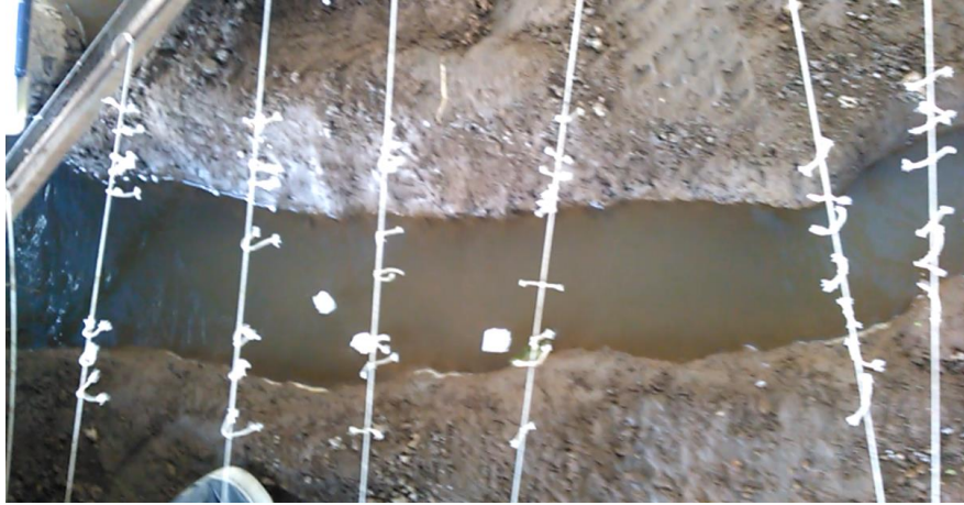
Gambar 3.12 Pengukuran kecepatan dengan benda apung (Sumber : Dokumentasi Pribadi)
