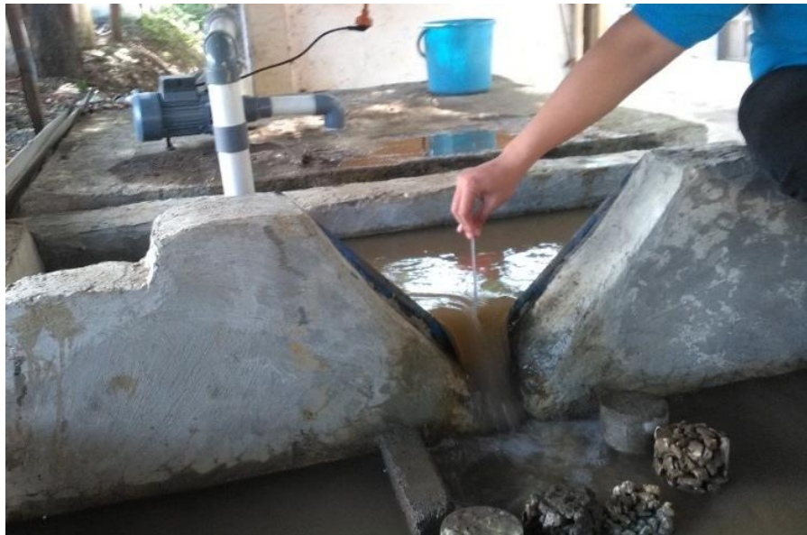
Gambar 3.7 Ketersediaan Alat ukur Debit V-Notch (Sumber : Dokumentasi Pribadi)
