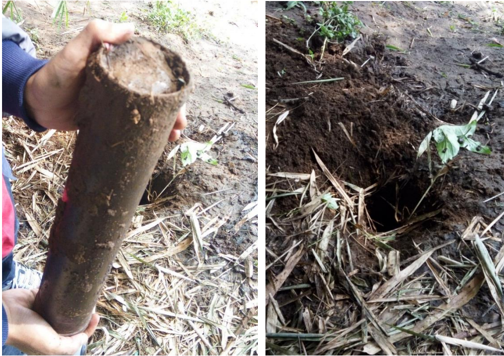
Gambar 3.9 Pengambilan sample tanah undisturbe (Sumber : Dokumentasi Pribadi)
