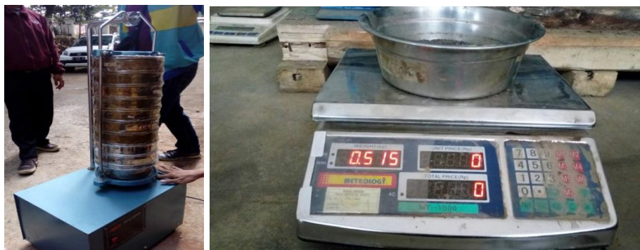
Gambar 3.15 Proses Pengayakan dan Penimbangan (Dokumentasi Pribadi)
