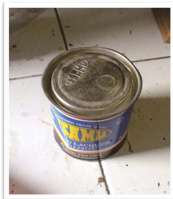
Gamba3 3.26 : Poxy (dempul poxy) Sumber: Dokumentasi penulis
