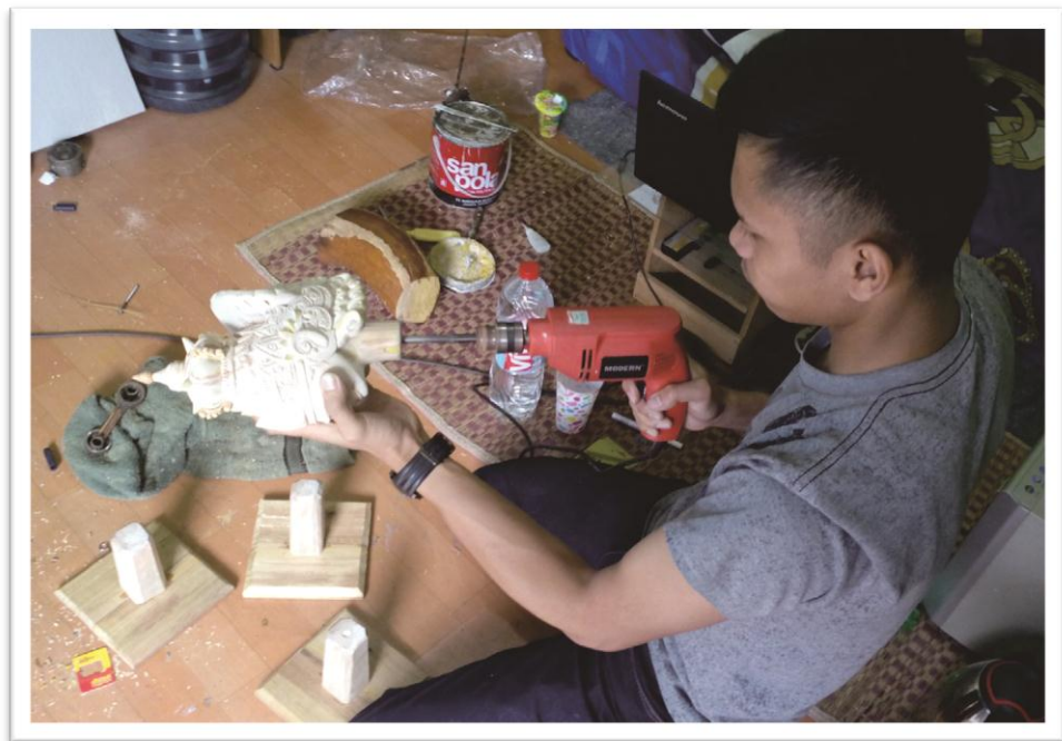
Gambar 3.68 : Proses pengeboran pada bagian leher wayang
