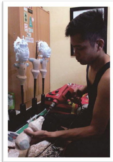
Gambar 3.75 : Proses pengeboran untuk membuat lubang sampurit dan benang
