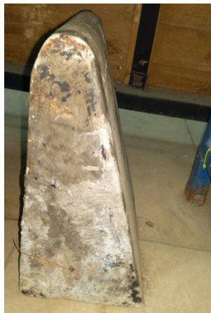
Gambar 3.3 Model spillway dengan kemiringan 70^{\circ}
