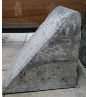
Gambar 3.2 Model spillway dengan kemiringan 50^{\circ}
