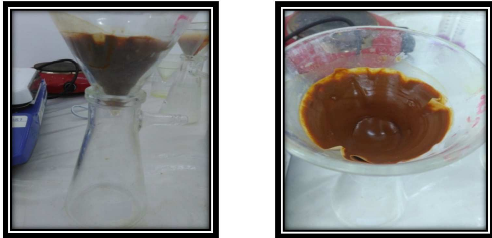
Gambar 3.4 (a) Proses penyaringan (tampak samping); (b) Hasil endapan (residu) bahan yang diendapkan
