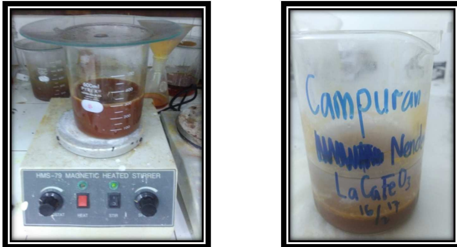
Gambar 3.3 (a) Campuran \text{La}_{0,9}\text{Ca}_{0,1}\text{FeO}_3 yang telah ditambahkan \text{NH}_4\text{OH} hingga pH 8, (b) Hasil endapan \text{La}_{0,9}\text{Ca}_{0,1}\text{FeO}_3
