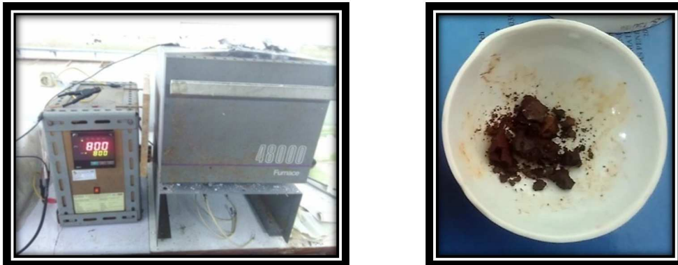
Gambar 3.6 (a) Tungku Kalsinasi, (b) Serbuk La_{0,9}Ca_{0,1}FeO_3 yang akan dikalsinasi
