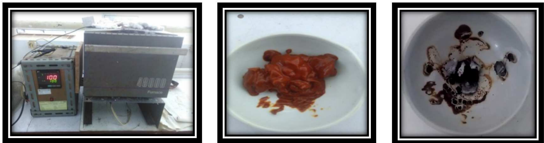
Gambar 3.5 (a) Tungku yang digunakan untuk pengeringan hasil endapan, (b) Endapan La_{0,9}Ca_{0,1}FeO_3 yang akan dikeringkan, (c) Endapan La_{0,9}Ca_{0,1}FeO_3 hasil dikeringkan
