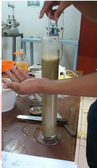
Gambar 3.16 Uji Hidrometer
