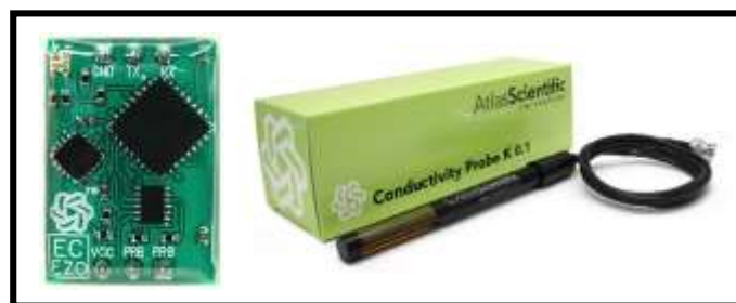
Gambar 3.8 2 buah konduktor grafit pada probe K 0.1 (Sumber : Datasheet EC Atlas-Scientific)
