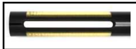
Gambar 3.8 2 buah konduktor grafit pada probe K 0.1 (Sumber : Datasheet EC Atlas-Scientific)
