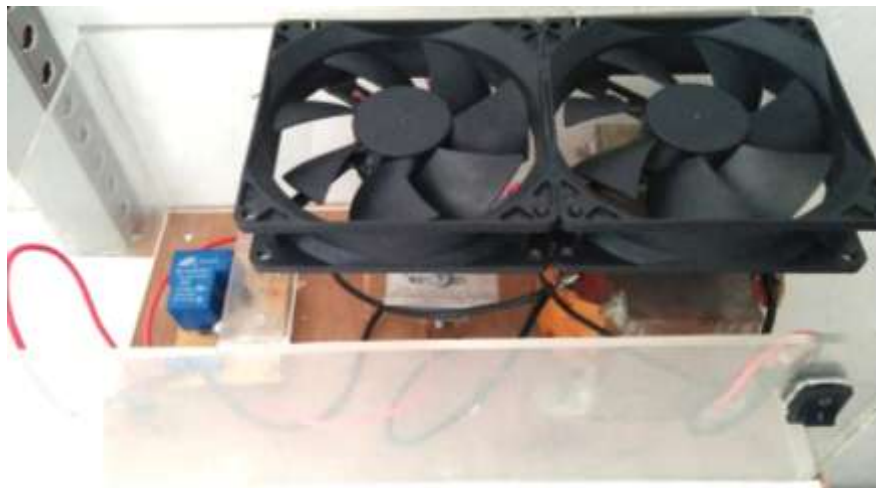
Gambar 3.4 Rectifier pada PLTH
