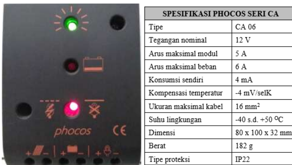
Gambar 3.3 Bentuk Fisik dan Spesifikasi Phocos CA 06
