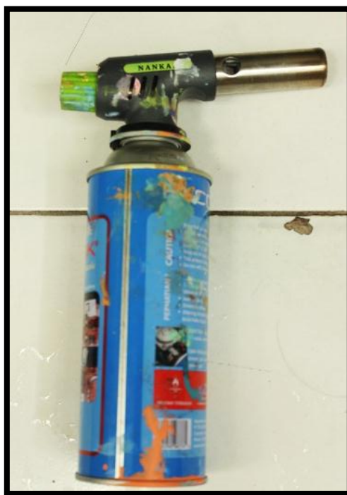
Gambar 3.9 Gas Torch (Sumber : Dokumentasi Penulis, 2017)
