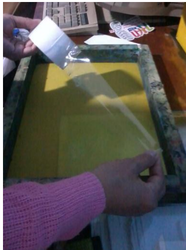
Gambar 3.15 Penutupan Screen oleh Lem dan Selotip (Sumber: dokumentasi pribadi 2016)
