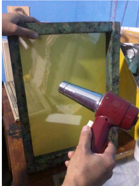
Gambar 3.16 Tahap Pengeringan Lem (Sumber: dokumentasi pribadi 2016)
