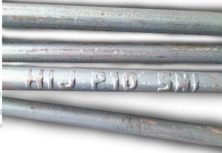
Gambar 3.17 Besi beton 10 mm (Dokumentasi pribadi)
