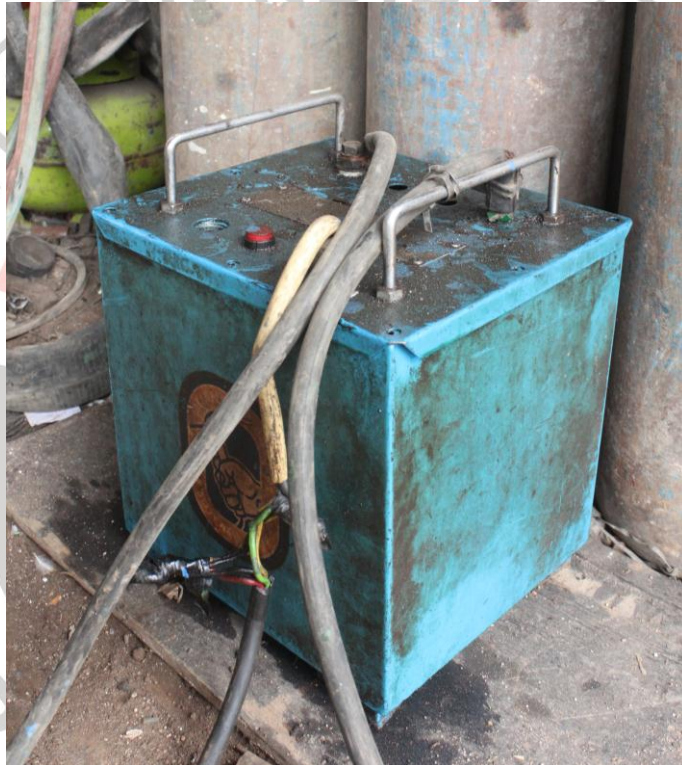
Gambar 3.13 Trafo (penghantar listrik pada tuas las listrik) (Dokumentasi pribadi)
