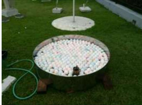
Gambar 3.15 Panci evaporasi B yang telah di isi air dan tertutup bola plastik
