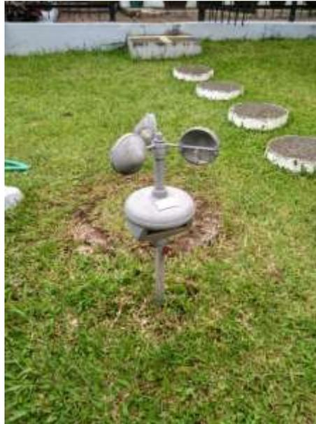
Gambar 3.6 Anemometer
