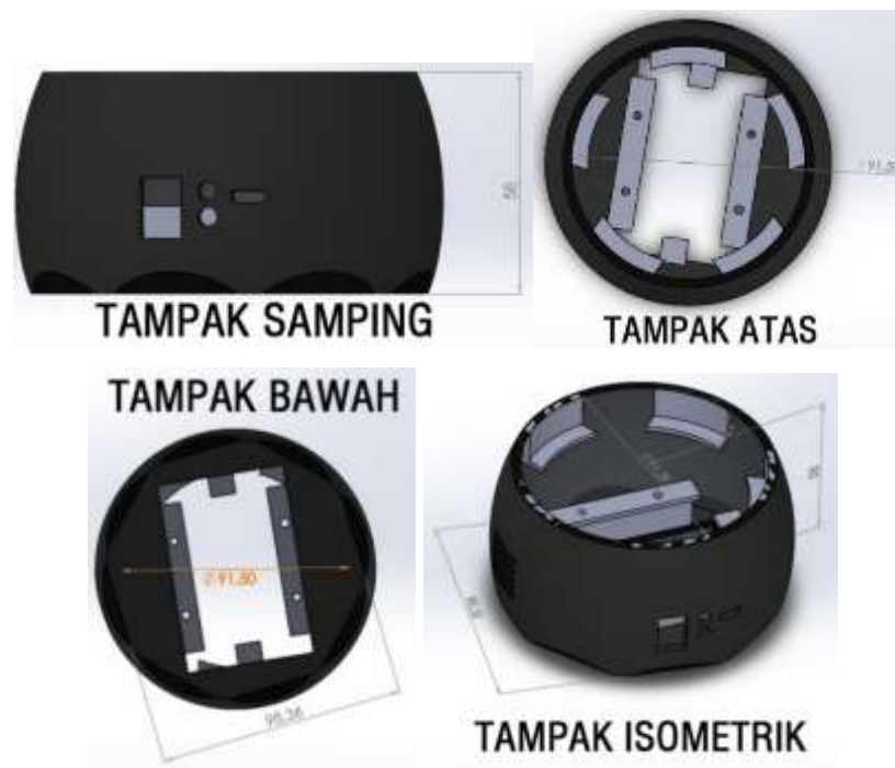
Gambar 3. 5 Desain mekanik Media Latihan Kelincahan ( Agility ) Berbasis Modul Wifi Pada Olahraga Bulutangkis
