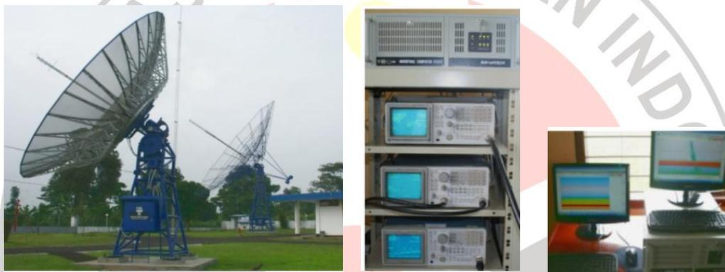
Gambar 3.1 Perangkat radiospektrograf.
