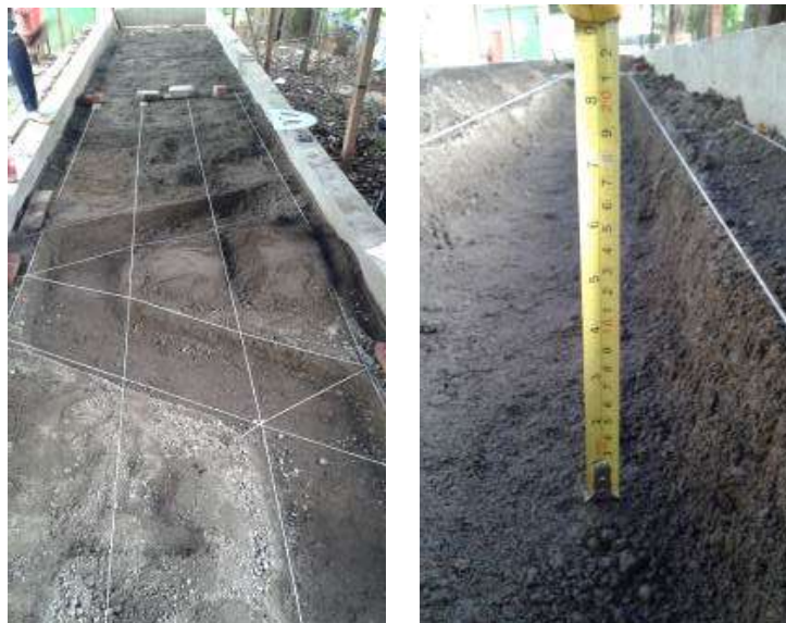
Gambar 3.7 Pembentukan alur sungai (Sumber : Dokumen Penelitian)
