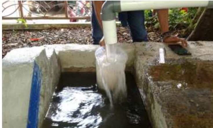
Gambar 1.27 Pengukuran debit metode volumetric run 1 (Sumber : Dokumentasi Pribadi)
