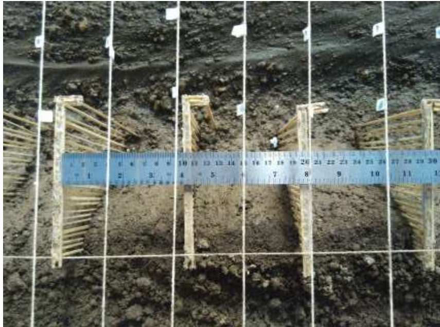
Gambar 1.52 Jarak antar krib 90^\circ (Sumber : Dokumentasi Pribadi)
