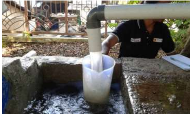
Gambar 1.33 Pengukuran debit metode volumetric run 2 (Sumber : Dokumentasi Pribadi)
