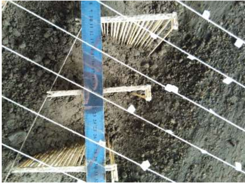
Gambar 1.50 Jarak antar krib 60^\circ (Sumber : Dokumentasi Pribadi)
