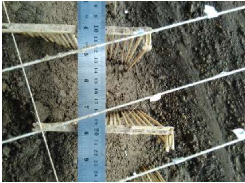
Gambar 1.54 Jarak antar krib 110^\circ (Sumber : Dokumentasi Pribadi)
