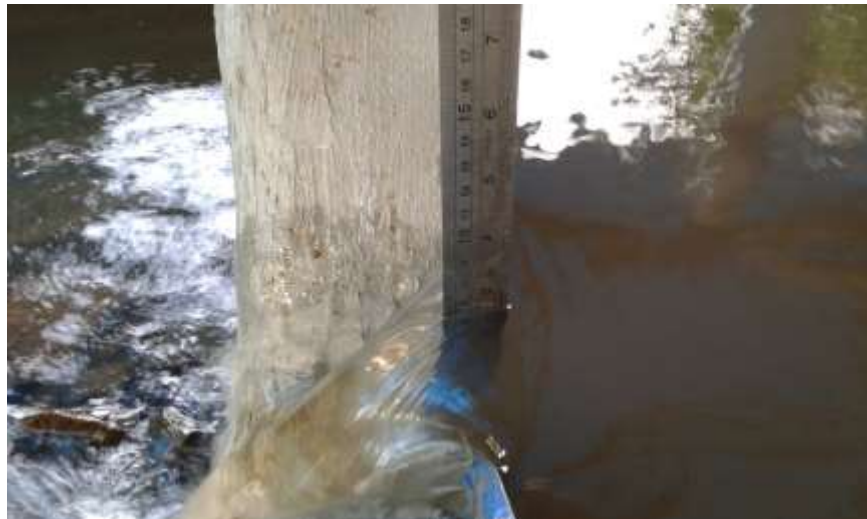
Gambar 1.32 Ketinggian air pada pintu ukur V-Notch run 2
