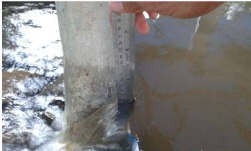
Gambar 1.26 Ketinggian air pada pintu ukur V-Notch run 1 (Sumber : Dokumentasi Pribadi)
