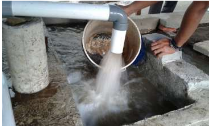
Gambar 1.45 Pengukuran debit metode volumetric run 4 (Sumber : Dokumentasi Pribadi)
