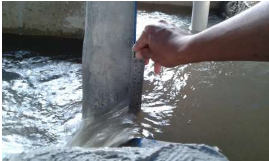
Gambar 1.44 Ketinggian air pada pintu ukur V-Notch run 4
