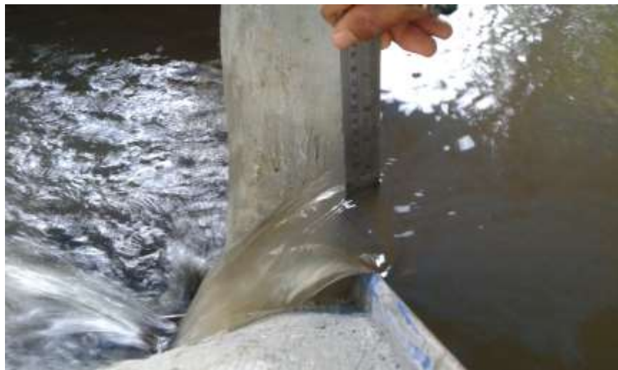
Gambar 1.38 Ketinggian air pada pintu ukur V-Notch run 3
