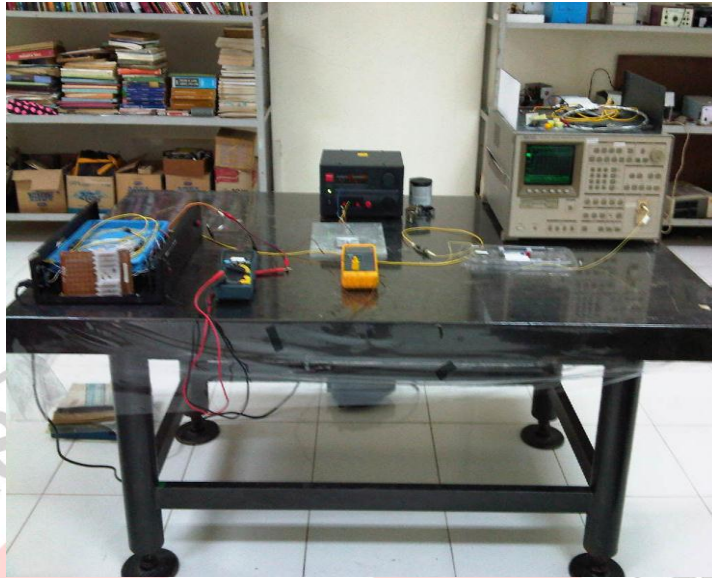
Gambar 3.8 Rancangan Percobaan Pengidentifikasian Pergeseran Panjang Gelombang Bragg Akibat Perubahan Suhu Pada FBG
