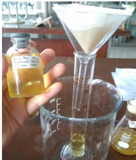
Gambar 3.9. Proses Penyaringan sampel kalus yang telah diekstraksi
