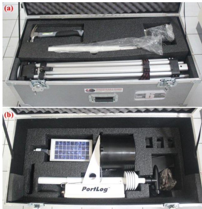
Gambar 3. 13. Portlog Rainwise sebelum dirakit. (a) Tripod dan aksesoris lain; (b) Panel surya, Rain Gauge dan Anemometer , serta kunci pengaman.
