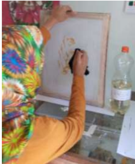
Gambar 3.29 Menggosok bagian Oil pada Screen dengan Kerosene (Sumber: Dokumentasi Penulis)
