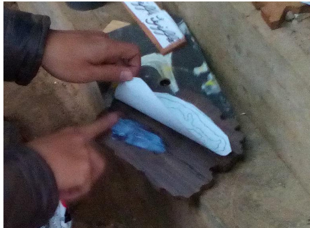
Gambar 3.340 Proses transfer gambar pada kayu Sumber: Dokumentasi pribadi
