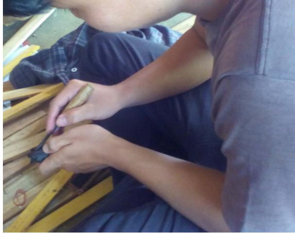
Gambar 3.53 Proses pengukiran menggunakan cukil Sumber: Dokumentasi pribadi
