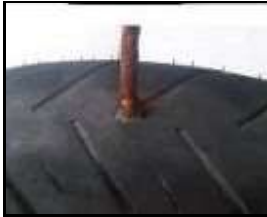
Gambar 7. Mencabut alat penusuk sehingga sumbu tertingga di ban
