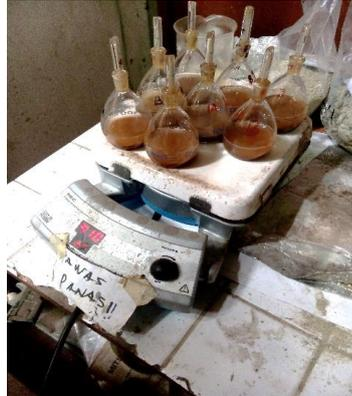
Gambar 3.5 Proses mengeluarkan udara yang terdapat dalam tanah dengan cara memanaskan piknometer
