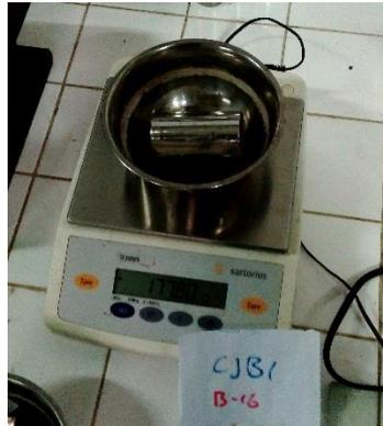
Gambar 3.3 Pengukuran berat cawan, ring dan sampel tanah
