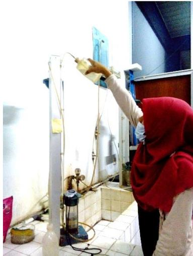
Gambar 3.7 Komponen alat pengujian koefisien rembesan menggunakan metode *falling head*.
