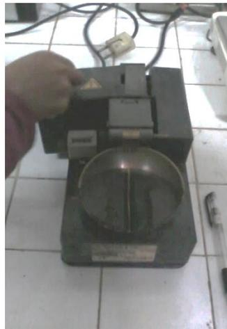
Gambar 3.10 Adonan tanah yang telah diletakkan kedalam alat Casagrande.
