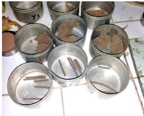
Gambar 3.12 Proses pembentukan adonan tanah membentuk seperti cacing.
