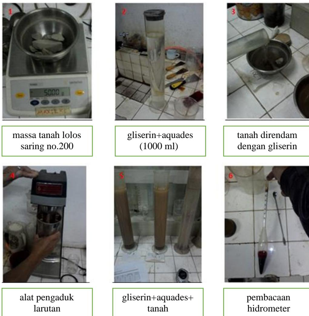
Gambar 3.9 Gambaran umum mengenai prosedur analisis hidrometer (Firmansyah, dkk, 2015)
