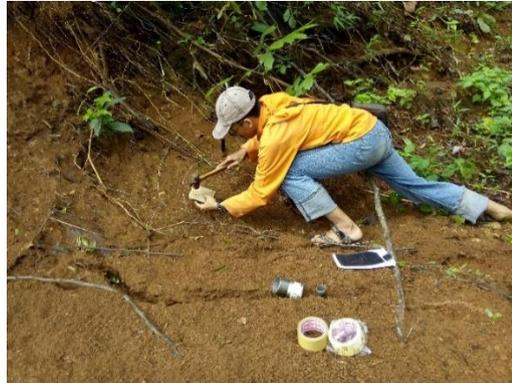
Gambar 3.2 Pengambilan sampel tanah bidang gelincir dan tanah bahan longsor.
