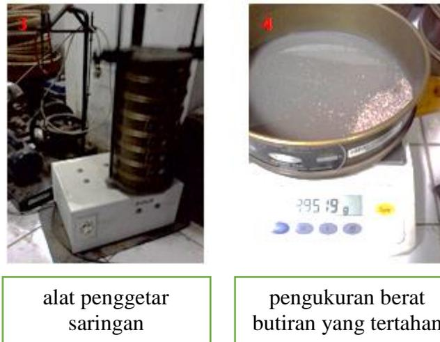
Gambar 3.8 Proses penyaringan menggunakan alat pengayak (Firmansyah, dkk, 2015)
