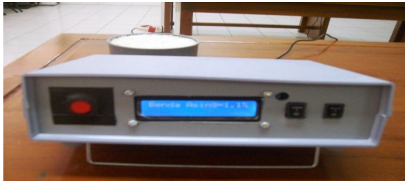
Gambar 3.28 Pengukuran nilai persentase benda asing dengan alat deteksi mutu beras.
