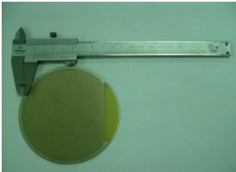
Gambar 3.17 Sensor kapasitif interdigit d = 0,3\text{mm} .
