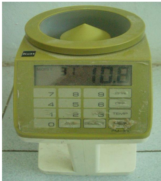
Gambar 3.26 Pengukuran nilai persentase kadar air dengan moisture meter.
