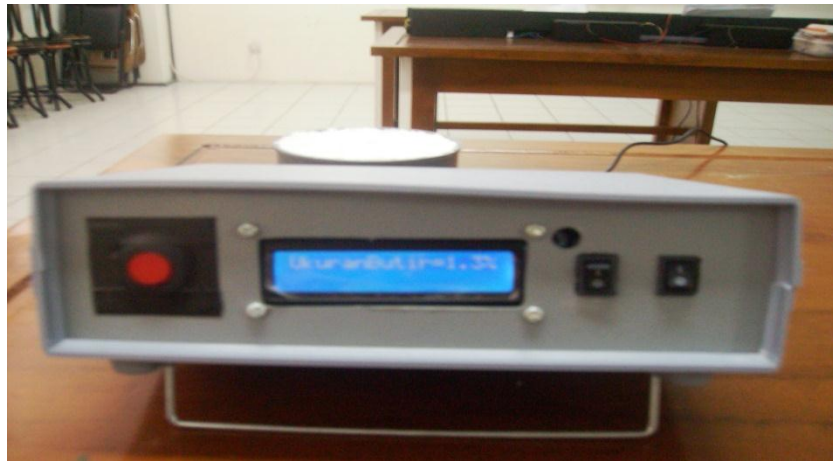
Gambar 3.29 Pengukuran nilai kepadatan ukuran butir beras dengan alat deteksi mutu beras.
