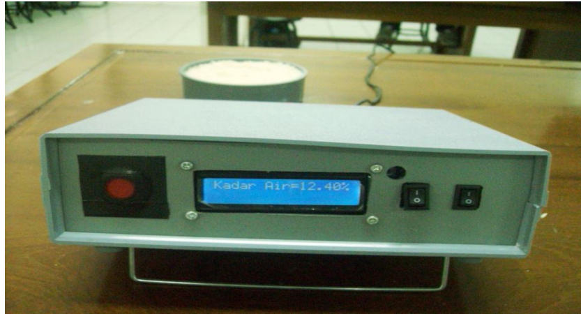
Gambar 3.27 Pengukuran nilai persentase kadar air dengan alat deteksi mutu beras.
