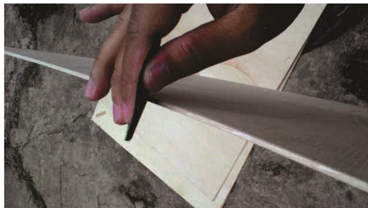
Gambar 3.40 Menghaluskan Sisi Triplek (Sumber: dokumentasi penulis, 2015)
