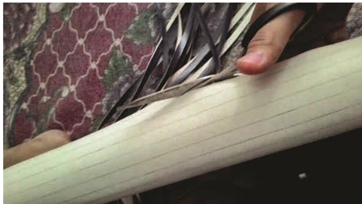
Gambar 3.34 Pemotongan Bilah Menggunakan Gunting (Sumber: dokumentasi penulis, 2015)
