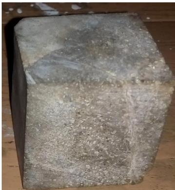
**Gambar III.3** Sampel batuan reservoir panas bumi KMJ-11 pada kedalaman 500 m
