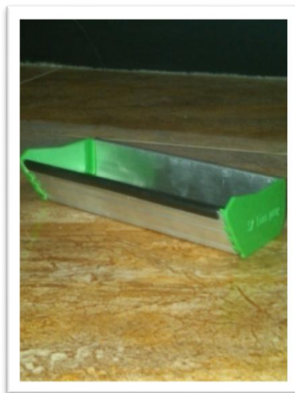
Gambar 3.15 Coater (Sumber: dokumentasi penulis)
