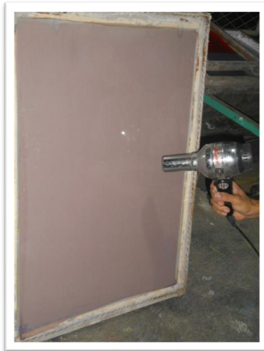
Gambar 3.31 Pengeringan Obat Afdruck Menggunakan Hairdryer (Sumber: dokumentasi penulis)
