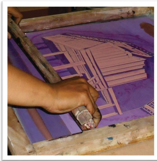
Gambar 3.39 Tahap Penyablonan (Sumber: dokumentasi penulis)
