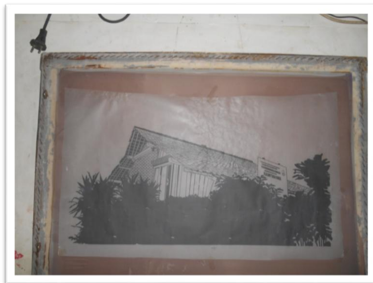
Gambar 3.32 Peletakkan Kertas Kalkir Bergambar diAtas Screen (Sumber: dokumentasi penulis)
