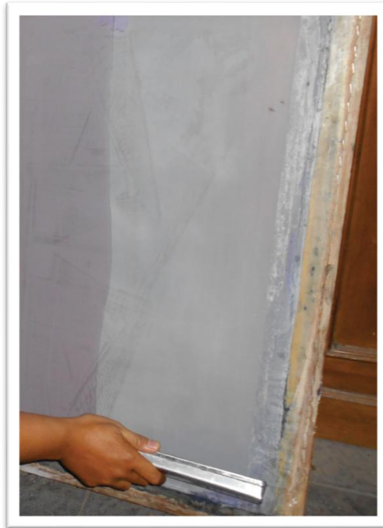
Gambar 3.30 Pengolesan Obat Afdruk pada Permukaan Screen (Sumber: dokumentasi penulis)
