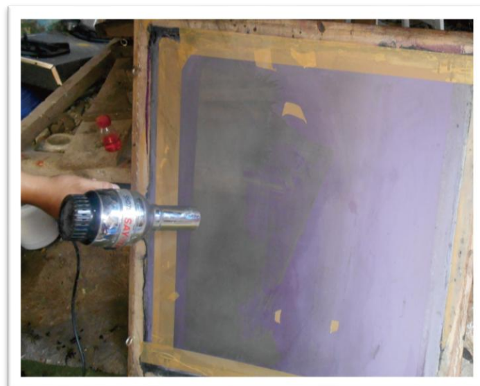
Gambar 3.35 Pengeringan Screen Setelah Proses Penyemprotan (Sumber: dokumentasi penulis)
