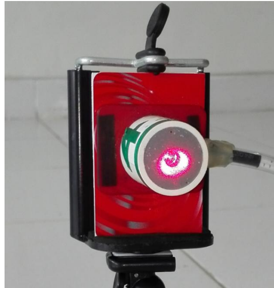
Gambar 3.6 Reseptor terhubung kabel yang menerima sinar laser
