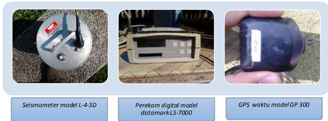
Gambar 3.3. Seismograf, terdiri dari GPS, sensor getar, dan seismometer
