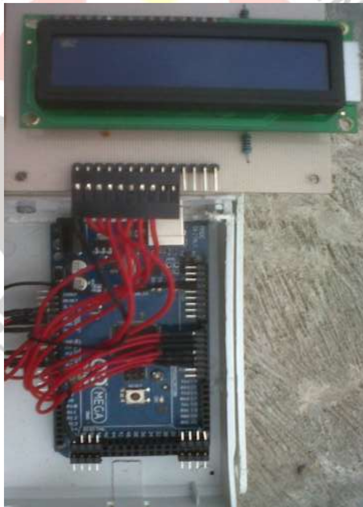
Gbr. 3.11 Pengkabelan arduino ke LCD
