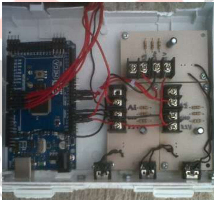
Gbr. 3.12 Pengkabelan arduino ke input sensor arus
