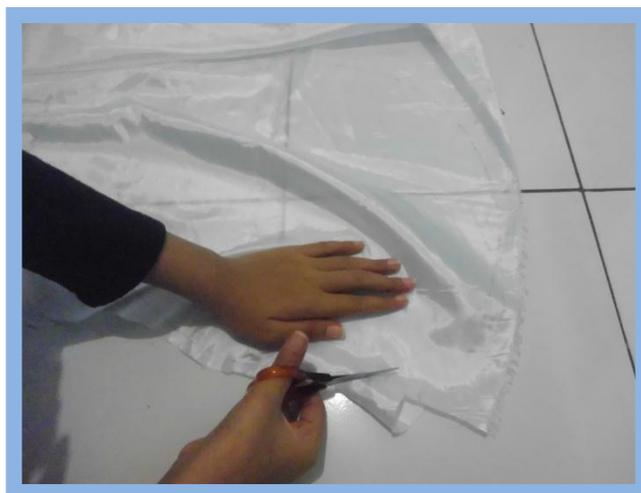
Gambar 3.33 Pemotongan kain puring yang sudah dipola
