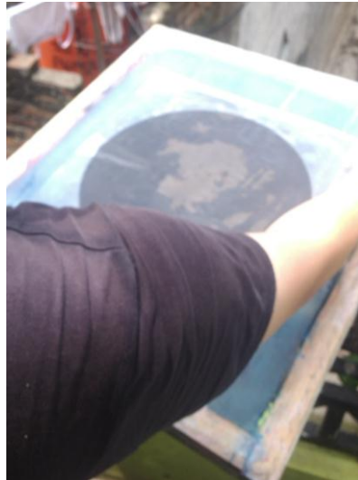
Gambar 3.39 Proses Afdruk dengan Bantuan Cahaya Matahari (Sumber: dokumentasi penulis)
