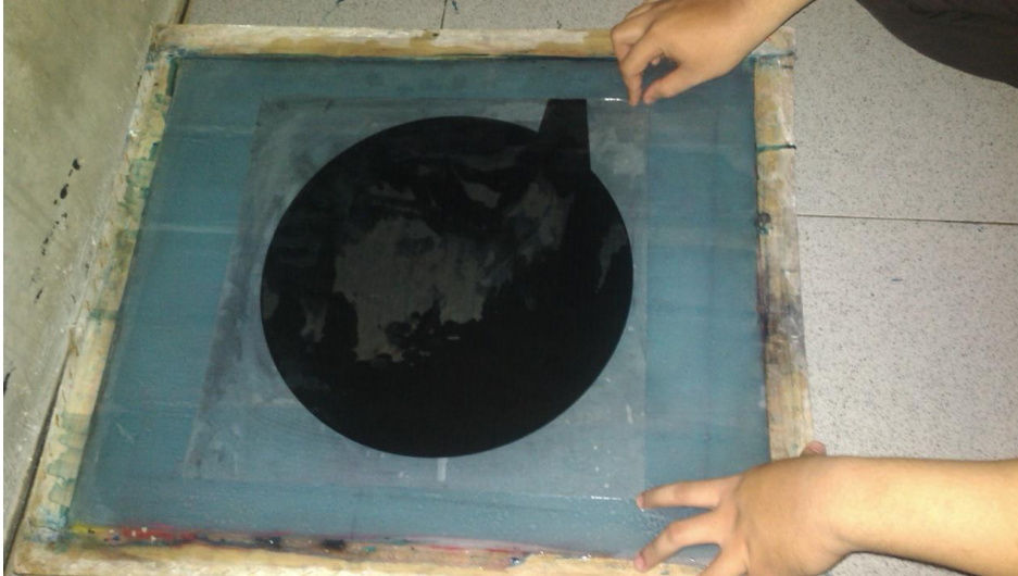
Gambar 3.38 Peletakkan Kertas Kalkir Bergambar di Atas Screen (Sumber: dokumentasi penulis)
