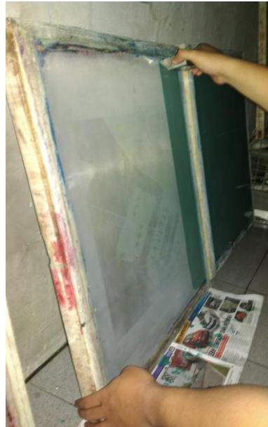
Gambar 3.36 Pengolesan Obat Afdruck pada Permukaan Screen (Sumber: dokumentasi penulis)
