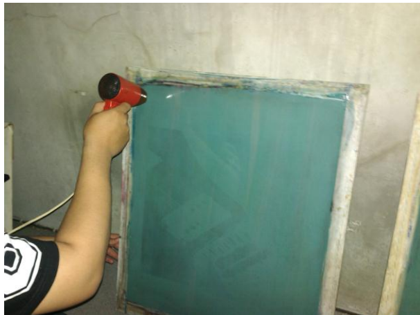
Gambar 3.37 Pengeringan Obat Afdruck Menggunakan Hairdryer (Sumber: dokumentasi penulis)
