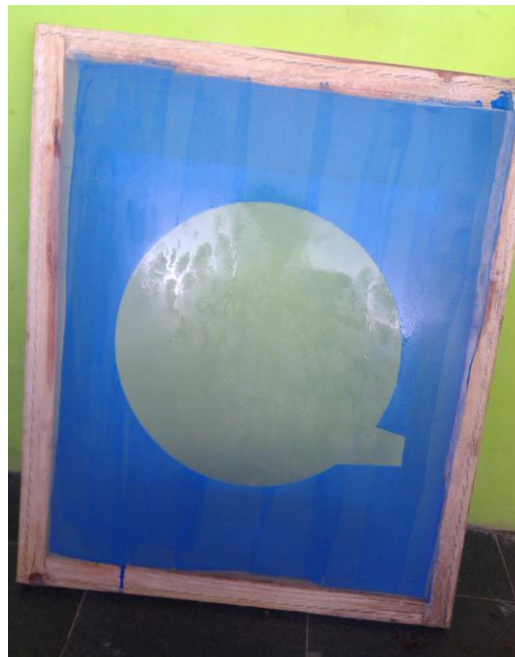
Gambar 3.41 Pengerinan Screen Setelah Proses Penyemprotan (Sumber: dokumentasi penulis)
