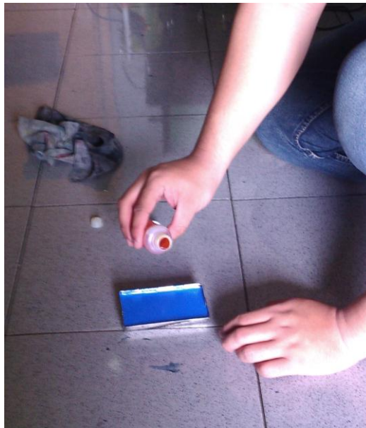
Gambar 3.35 Pencampuran Emulsion dan Sensitizer (Sumber: dokumentasi penulis)
