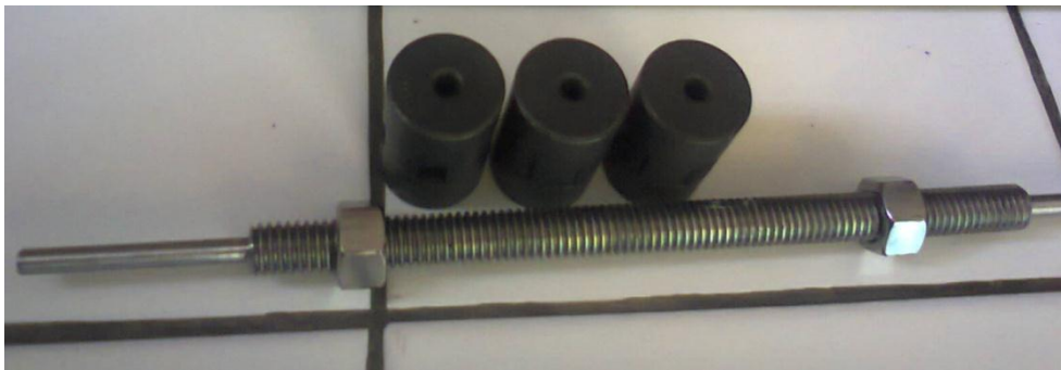
Gambar 3. 4. Screw 1/2 " dan flexible coupling untuk sumbu z
